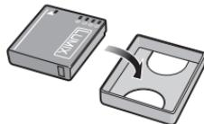
**Wenn Sie den Akku versehentlich fallen lassen, untersuchen Sie das Akkugehäuse und die Kontakte auf Beschädigungen.**
