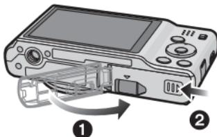
**1** Far scorrere la leva di sgancio nella direzione della freccia, e chiudere completamente lo sportello della scheda/delle batterie.
