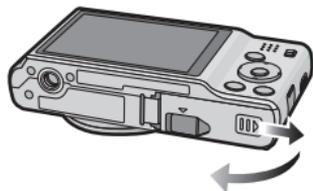
**2** Batteria: Facendo attenzione all'orientamento della batteria, inserirla fino in fondo finché non si sente uno scatto, quindi controllare che sia bloccata dalla leva (A). Tirare la leva (A) nella direzione indicata dalla freccia per rimuovere la batteria.
