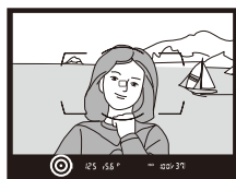
Indicateur de mise au point
