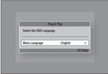
2. Mit Hilfe der ►▲▼ Tasten die gewünschte Sprache auswählen und anschließend die **ENTER** Taste drücken.
