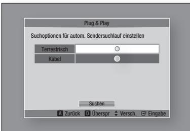
6. Mit Hilfe der ▲▼ Tasten die gewünschte Antennenquelle auswählen und anschließend die **ENTER** Taste drücken.
