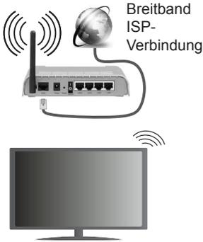
Ein WLAN-N-Router (IEEE 802.11a/b/g/n) mit den simultanen Frequenzbändern von 2.4 und 5 GHz ist darauf ausgelegt, eine größtmögliche Bandweite zu ermöglichen. Optimiert für zügiges und schnelleres HD-Video-Streaming, schnellere Dateiübertragung sowie Online-Spiele (Wireless-Gaming).
