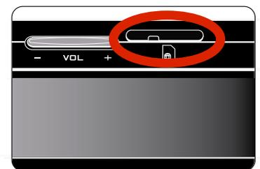
**ACHTUNG:** *Bevor Sie eine Sim Card einstecken oder ausstecken, stellen Sie sicher, dass Ihr Gerät völlig abgeschaltet ist!*
