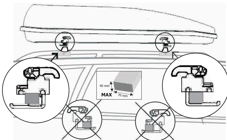
**I** Verificare ulteriormente che tutto il sistema sia correttamente fissato e che il box non possa muoversi sulle barre.
