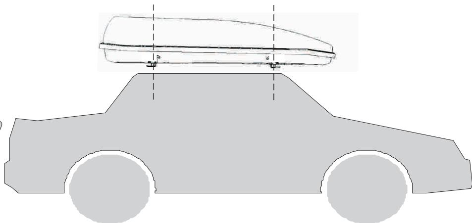
(I) Posizionare il Box sulle barre portatutto in posizione centrale rispetto all'asse della vettura.
