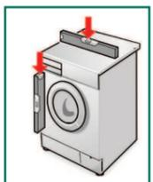
Ausrichtung der Waschmaschine mit Wasserwaage überprüfen, evtl. korrigieren.
