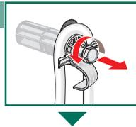
3. Alle 3 Transportsicherungen komplett entfernen und die Netzleitung aus den Halterungen nehmen, je nach Modell.
