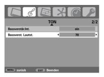
Wenn ein aktiver Super Woofer am rückseitigen TV-Anschluss Woofer Out angeschlossen ist, wählen Sie im Menü EINSTELLUNG die Option AV-Anschluss aus, und drücken Sie ▼, um die Option Bass zu markieren. Wählen Sie dann mit ◀ oder ▶ die Einstellung Externe aus (siehe Abschnitt "Auswahl der Eingänge und AV-Anschlüsse").
