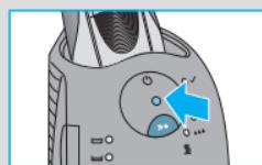
Under rengjøringen blinker det aktuelle indikatorlyset for rengjøring. Hvert rengjøringsprogram består av flere sykluser, hvor rensevæsken skyldes gjennom barberhodet og en varmetørkingsprosess tørker barbermaskinen. Avhengig av valgt program, vil den totale rengjøringstiden variere fra 32 til 43 minutter.
