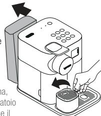
Quando si apre l'imballo della macchina, rimuovere la pellicola protettiva, il serbatoio dell'acqua, la vaschetta raccogligocce e il contenitore delle capsule usate. Regolare la lunghezza del cavo e fissare quello in eccesso nell'apposito vano sotto la macchina.
