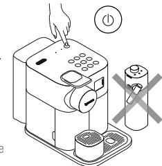
**WICHTIG:** Der Menümodus wird automatisch nach 30 Sekunden verlassen, wenn keine Handlung erfolgt. Er kann auch manuell verlassen werden, indem die Tasten (milk) und (flat white) für 3 Sekunden gleichzeitig gedrückt werden.
