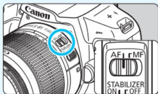
**Positionnez le sélecteur de mode de mise au point de l'objectif sur <AF>** (p. 44).
