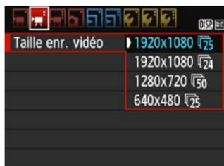
L'option de menu [ **2** : **Taille enr. vidéo** ] vous permet de sélectionner la taille d'image de la vidéo [\*\*\*\*x\*\*\*\*] et la cadence d'enregistrement [ **25** ] (images enregistrées par seconde). L'élément **25** (cadence d'enregistrement des images) change automatiquement selon le réglage [ **2** : **Système vidéo** ].
