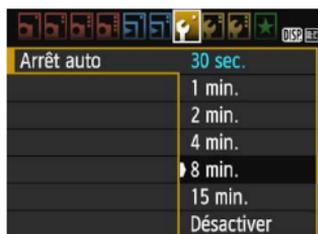
Dans l'onglet [👉1], sélectionnez [Arrêt auto], puis appuyez sur <SET>. Sélectionnez le réglage désiré, puis appuyez sur <SET>.
