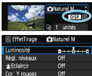
À l'étape 4 de la page 246, sélectionnez un effet d'impression. Lorsque l'icône <☰> s'illumine à côté de <DISP.>, vous pouvez appuyer sur la touche <DISP.> pour ajuster l'effet d'impression. Les éléments ajustables ou affichables dépendent de la sélection faite à l'étape 4.
