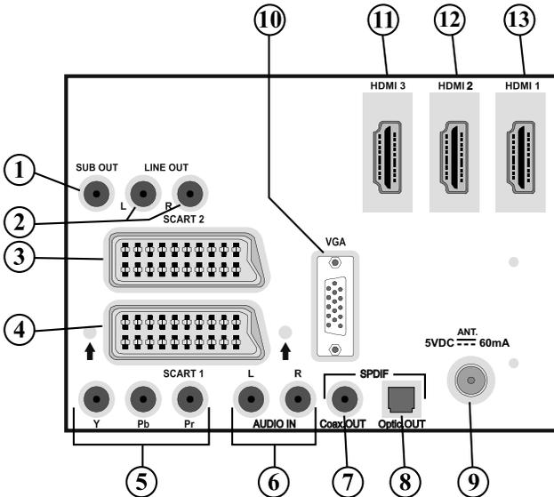
1. Am Anschluss **Subwoofer Out** können Sie einen externen aktiven Subwoofer anschließen, um so einen wesentlich tieferen Basseffekt zu erzeugen. Verwenden Sie ein geeignetes RCA-Kabel, um das Gerät an einen Subwoofer anzuschließen.
