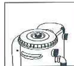
Ziehen Sie das Luttreinigungsventil fest an
