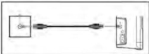
L'antenne-câble FM permet une réception appropriée. Branchez l'antenne-câble sur la prise antenne 2. Elle doit être orientée sur toute sa longueur en fonction de la meilleure réception possible. En cas de mauvaise réception, il est recommandé de commuter en mode MONO à l'aide de la touche ST/MO.
