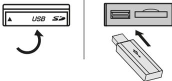
Wenn der USB-Speicher mit dem Hauptgerät verbunden ist, werden die Geräteinformationen angezeigt.
