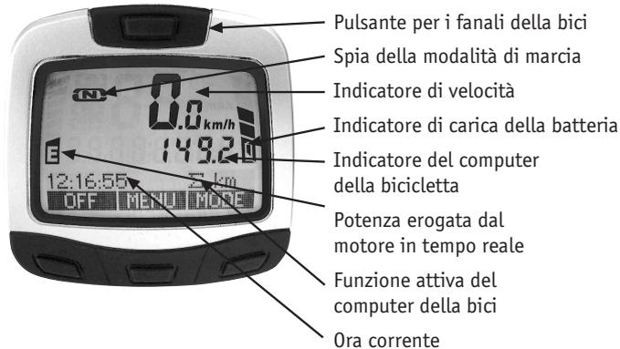
Fig. 19 – unità di controllo con display LCD
