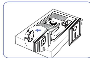
Insérez le support de base sur le socle dans la direction de la flèche.
