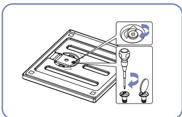
Fixez fermement la vis (à l'aide d'un tournevis ou d'une pièce de monnaie) au bas de la base-support.
