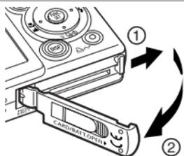
**1 Schieben Sie die Abdeckung für SD-Karten-Steckplatz und Akkufach in Pfeilrichtung.**
