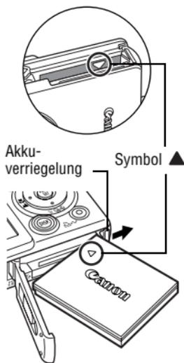
**2** Halten Sie die Akkuverriegelung gedrückt, während Sie den Akku vollständig einschieben, bis er hörbar einrastet.
