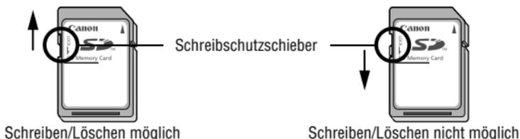
Stellen Sie sicher, dass Sie die SD-Karte vor dem Einsetzen in die Kamera richtig herum halten. Die Kamera könnte beschädigt werden, wenn sie versehentlich falsch herum eingesetzt wird.
