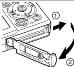
**1** Schieben Sie die Abdeckung für SD-Karten-Steckplatz und Akkufach in Pfeilrichtung.
