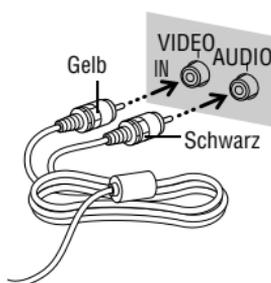
**3 Stecken Sie die Stecker am anderen Ende des AV-Kabels in die Audio- und die Video-Eingangsbuchse des Fernsehgeräts.**
