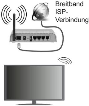
Ein WLAN-Router (IEEE 802.11a/b/g/n) mit den simultanen Frequenzbändern von 2,4 und 5 GHz ist darauf ausgelegt, eine größtmögliche Bandbreite zu ermöglichen. Optimiert für zügiges und schnelleres HD-Video-Streaming, schnellere Datenübertragung sowie Online-Spiele (Wireless-Gaming).
