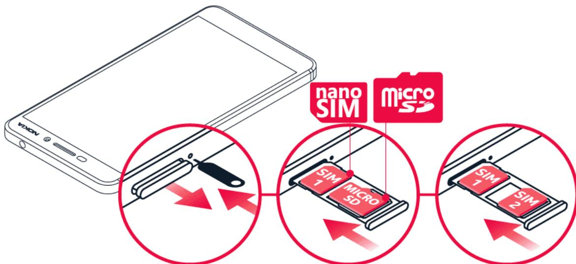
1. Um den SIM-Kartenhalter zu öffnen, setzen Sie den Öffner in die Vertiefung neben dem Halter und drücken Sie ihn hinein.
