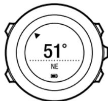
Der Kompass schaltet sich nach einer Minute in den Energiesparmodus. Mit [Start Stop] können Sie den Kompass wieder aktivieren.
