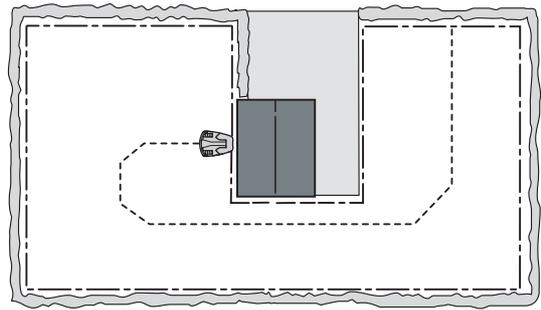
Stellen Sie die Ladestation nicht in Ausbuchtungen des Arbeitsbereichs auf. Links und rechts neben der Ladestation muss ein gerades Begrenzungskabel verlegt werden können, das mindestens 1,5 m lang ist. Das Kabel muss an der Rückseite der Ladestation entlang gerade herausführen. Anders gewählte Standorte könnten dazu führen, dass der Mähroboter von der Seite her in die Ladestation einfährt und dadurch nur schwer andocken kann.
