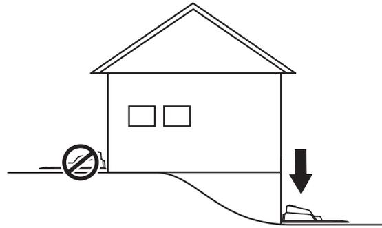
Die Ladestation sollte nicht auf einer Insel aufgestellt werden, da dies das optimale Auslegen des Suchkabels erschwert. Sollte es notwendig sein, die Ladestation auf einer Insel aufzustellen, muss das Suchkabel mit der Insel verbunden werden. Betrachten Sie hierzu die nebenstehende Abbildung. Weiter Informationen finden Sie unter *3.4 Installation des Begrenzungskabels* auf Seite 23.
