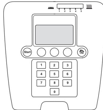
Wenn die **Stop**-Taste gedrückt und die Abdeckung geöffnet wurde, erscheint das Bedienfenster. Uhrzeit, ausgewählter Betriebsmodus, Anzahl der Mähstunden und Batteriestatus werden angezeigt.
