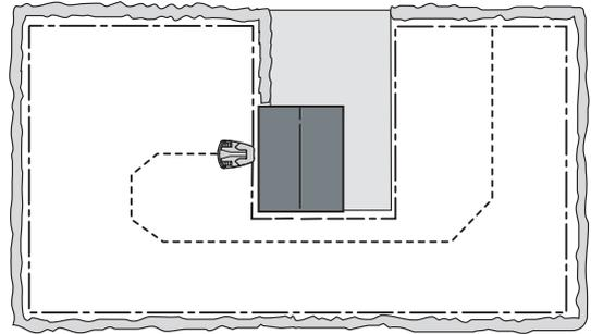
Wenn die Batterie voll geladen ist, verlässt der Mähroboter die Ladestation in einer zufällig gewählten Richtung innerhalb des Ausgangssektors von  $90^\circ$  -  $270^\circ$ .
