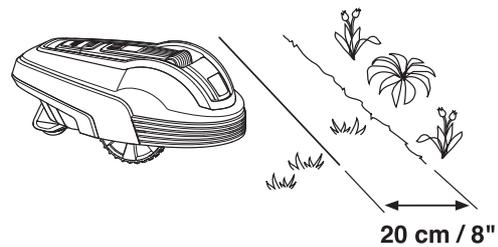
Wenn der Arbeitsbereich an einen Weg mit Steinpflaster oder Ähnlichem grenzt, der sich auf gleicher Ebene wie der Rasen befindet, ist der Mähroboter in der Lage, auch ein wenig über den Weg zu fahren. Das Begrenzungskabel sollte dann 5 cm von der Wegkante entfernt verlegt werden.
