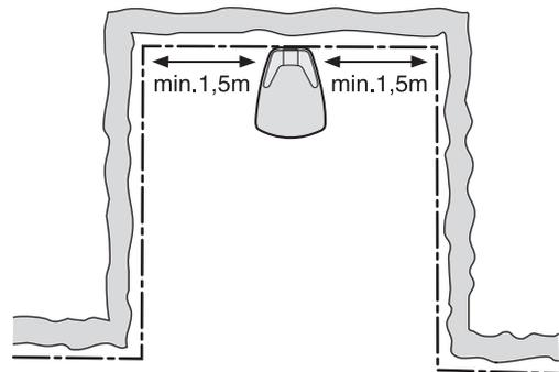
Stellen Sie die Ladestation nicht in Ecken des Arbeitsbereichs auf. Links und rechts neben der Ladestation muss das Begrenzungskabel in einer Länge von 1,5 m gerade verlegt werden können.
