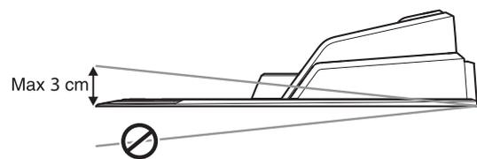
Bei der Platzierung der Ladestation muss darauf geachtet werden, dass die Basisplatte nicht verbogen wird.
