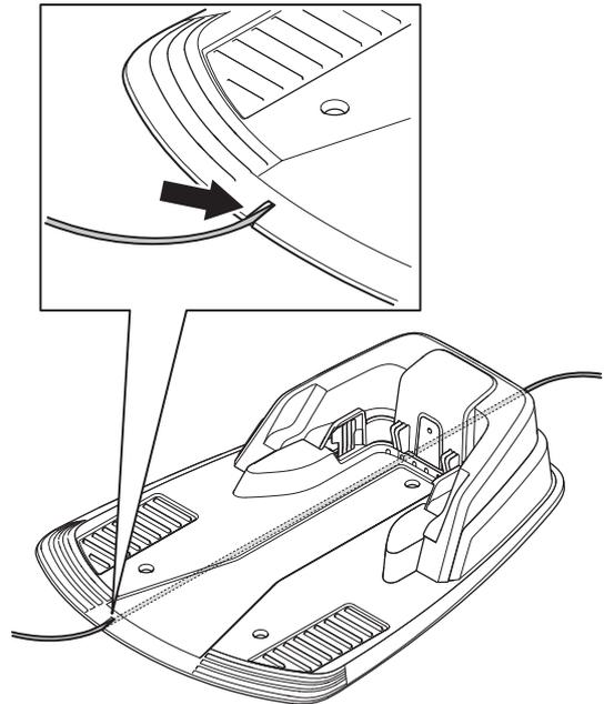
2. Den Verbinder auf dieselbe Weise wie das Begrenzungskabel gemäß den Anweisungen in 3.5 *Anschließen des Begrenzungskabels* auf Seite 29 oben mit dem Suchkabel verbinden. An den Kontaktstift an der Ladestation anschließen, der mit „Guide“ gekennzeichnet ist.
