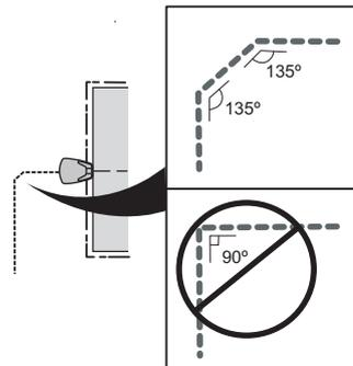
6. Das Suchkabel mit dem Begrenzungskabel mithilfe eines Verbinders zusammenfügen:
