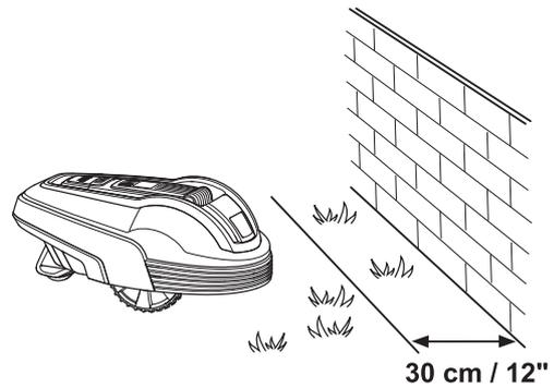
Wenn der Arbeitsbereich an einen kleinen Graben, wie zum Beispiel ein Blumenbeet, oder eine kleine Anhöhe oder eine niedrige Steinkante (3 - 5 cm) grenzt, sollte das Begrenzungskabel in einem Abstand von 20 cm in den Arbeitsbereich hinein verlegt werden. Dadurch wird verhindert, dass die Räder in den Graben oder auf die Steinkante fahren.
