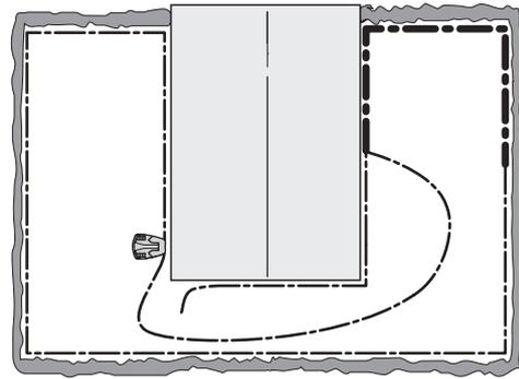
5. Sobald der Bruch aufgespürt wurde, muss der beschädigte Abschnitt durch ein neues Kabel ersetzt werden. Der beschädigte Abschnitt kann, sofern möglich, aus dem Begrenzungskabel herausgeschnitten werden. Stets Originalverbinder verwenden.
