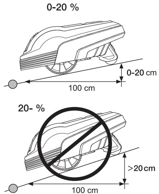
Der Mähroboter ist in der Lage, innerhalb des Arbeitsbereiches Abhänge mit einer Neigung von 25 cm pro Meter (25 %) zu bearbeiten. Bereiche mit größeren Neigungen müssen durch das Begrenzungskabel abgegrenzt werden.
