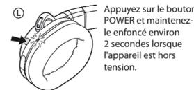
Appuyez sur le bouton POWER et maintenez-le enfoncé environ 2 secondes lorsque l'appareil est hors tension.
