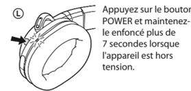
Appuyez sur le bouton POWER et maintenez-le enfoncé plus de 7 secondes lorsque l'appareil est hors tension.
