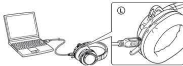
La carga da comienzo en cuanto se conectan la unidad y el ordenador, y finaliza en unas 6 horas como máximo, momento en que el indicador (rojo) se apaga automáticamente.
