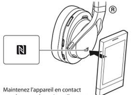
Maintenez l'appareil en contact avec le smartphone jusqu'à ce que le smartphone vibre.
