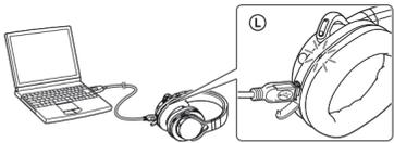
Der Ladevorgang beginnt, sobald das Gerät und der Computer miteinander verbunden sind. Das Aufladen ist nach etwa höchstens 6 Stunden abgeschlossen, und die (rote) Anzeige erlischt automatisch.
