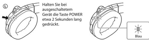
2 Starten Sie am **Bluetooth**-Gerät das Herstellen der **Bluetooth**-Verbindung.
