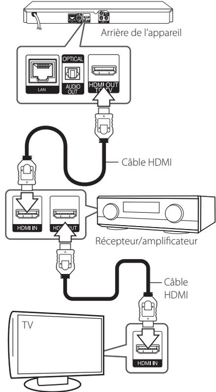
Raccordez la prise de sortie HDMI de l'amplificateur à la prise d'entrée HDMI de votre téléviseur à l'aide d'un câble HDMI si votre amplificateur possède une prise de sortie HDMI.
