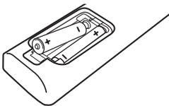
Retirez le couvercle du compartiment des piles à l'arrière de la télécommande, puis insérez deux piles R03 (AAA) en respectant la polarité + et -.
