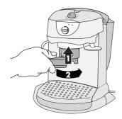
Placer le porte-filtre contre le dispositif d'ébullition de par en-dessous
