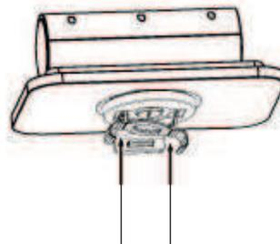
1. Setzen Sie die dickeren Stifte der Halterung in die Montagelöcher auf der linken Seite ein.
