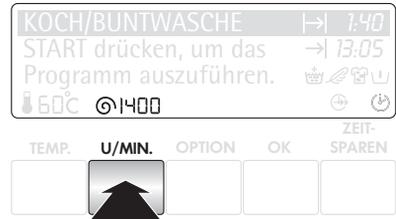
Die maximale Schleuderdrehzahl beträgt 1600 U/min.
