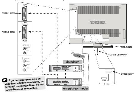
Avant de raccorder les câbles d'antenne vidéo et audio, enlevez les cache-bornes arrière et latéral en serrant les languettes et en tirant les caches vers l'extérieur.
