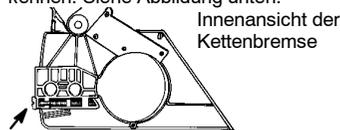
4. Drehen Sie die Verstellerschraube per Hand gegen den Uhrzeigersinn, bis der Verstellstift den Stoppschalter gerade so berührt. Dadurch kommt der Stift der korrekten Position sehr nahe. Eine Feineinstellung kann bei der Montage der Schiene erforderlich werden.
