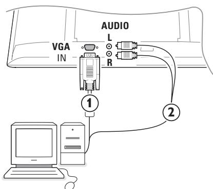
① Csatlakoztassa a VGA ① csatlakozókábel egyik végét a számítógép video-kártyájához, a másik végét pedig a televíziókészülék alsó részén található **VGA IN** csatlakozóhoz. Megbízhatóan erősítse meg a csatlakozásokat a dugón található csavarok segítségével.
