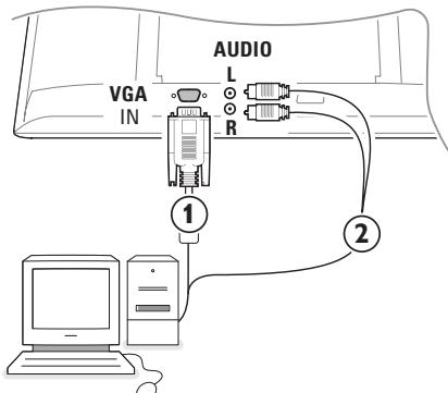
① Συνδέστε το ένα άκρο του καλωδίου VGA ① στην κάρτα οθόνης του υπολογιστή και το άλλο άκρο στην υποδοχή **VGA IN** στο κάτω μέρος της τηλεόρασης. Στερεώστε γερά τα βύσματα σφίγγοντας τις βίδες.
