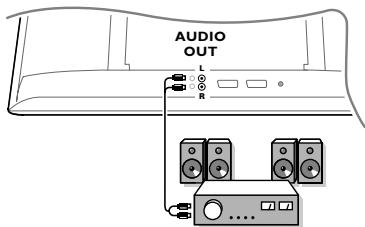
Para efectuar una ligação a um sistema sonoro de alta fidelidade, utilize um cabo de conexão áudio, e ligue as saídas L e R do televisor às entradas **AUDIO IN L** e **R** do amplificador do seu sistema de alta fidelidade.
