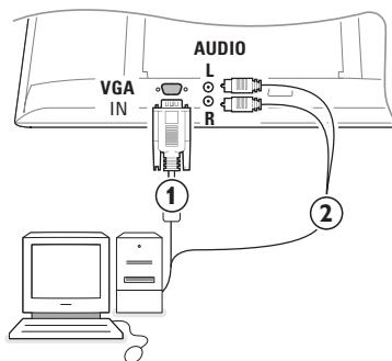
❶ Присоедините один конец кабеля стандарта VGA ① к видеокарте компьютера, а другой его конец к разъему **VGA IN** (Вход VGA) на нижней части телевизора. Надежно закрепите разъемы с помощью винтов на вилке.
