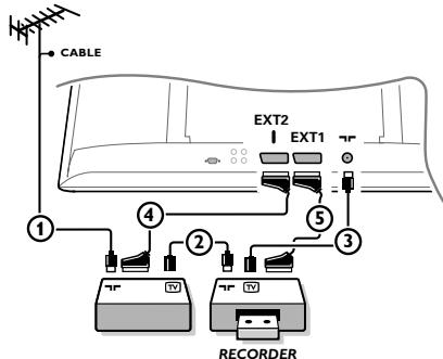
Conecte los cables de antena ①, ② y ③ tal como se muestra (sólo si su dispositivo periférico tiene una entrada/salida de antena de TV).
