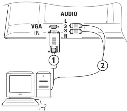
❶ Tilslut den ene ende af et VGA-kabel ① til videokortet på computeren og den anden ende til **VGA IN**-stikdåsen nederst på tv'et. Fastgør stikkene godt med skruerne på stikket.
