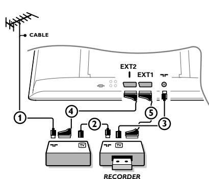
Подключите, как показано на рисунке, антенные кабели ①, ② и ③ (только в том случае, если дополнительное устройство имеет телевизионные антенные входы/выходы). Качество изображения улучшится, если Вы подсоедините оборудование с помощью еврокабеля ④ или ⑤ к входам EXT1 или EXT2.
