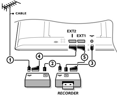
Die Antennenkabel ①, ② und ③ so anschließen, wie gezeigt wird (nur wenn Ihr Peripheriegerät TV-Antennen-Ein-/Ausgang hat). Ihr Gerät mit einem Eurokabel ④ oder ⑤ an einen von den Eurosteckverbindungen **EXT1** oder 2 anschließen, um eine bessere Bildqualität zu erhalten.
