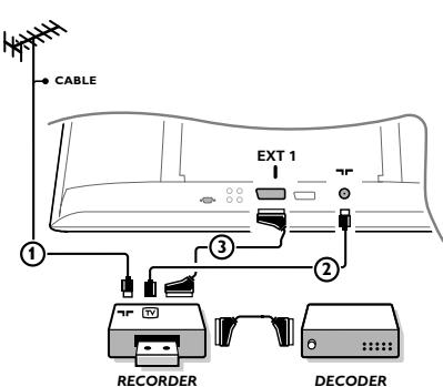
Csatlakoztassa az ábra szerint az ① és ② antennakábelt. Kiemelkedő képmínőség biztosítása érdekében ajánlatos a ③ eurokábel is csatlakoztatni. Ha készülékén nincs eurokábeles csatlakozó, akkor az antennakábeles csatlakoztatás az egyetlen megoldás. Ekkor szükségesen válik a videofelvező berendezése vizsgálójének beállítása és elmentése 0 programszám alatt, vagy a vizsgálójel mentése 90 és 99 közötti programszám alatt, ld. Kézi beállítás, 7.old. Lásd a video berendezés használati utasítását!
