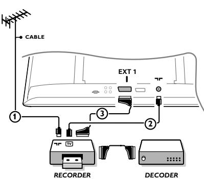
Podľa obrázku pripojte anténne káble ①, ② a euro-kábel ③, vďaka ktorému dosiahnete optimálnu kvalitu obrazu. Ak váš videorekordér nemá eurokonektor, jediný spôsob pripojenia zostáva cez antény kábel. Bude potrebné nalaďiť televízor na testovací signál videorekordéru a priradiť mu predvolbu 0 alebo 90 až 99 – vid. „Manuálna inštalácia“ na str. 7. Pozrite si príručku k videorekordéru.
