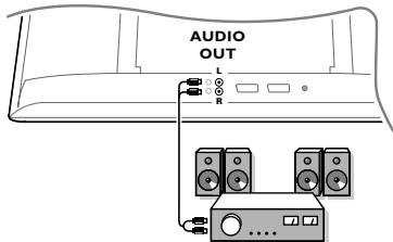
For å koble til et stereoanlegg bruker du audiokabel. Kabelen skal gå mellom **L** og **R**-utgangene på TV-apparatet og inngangen **AUDIO IN L** og **R** på stereoanlegget.
