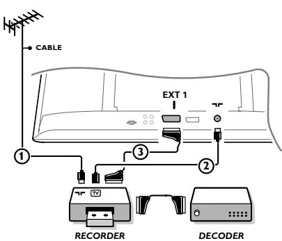
Podłącz kable antenowe ①, ② oraz, aby uzyskać optymalną jakość obrazu, kabel Euro ③, jak to pokazane jest na rysunku. Jeżeli Twoje urządzenie rejestrujące nie posiada łącznika Euro, jedyne połączenie, które jest możliwe - to połączenie poprzez kabel antenowy. Następnie musisz wyszukać sygnał testowy i nadać mu numer programowy 0, albo wprowadzić sygnał testowy do pamięci pod numerem programowym od 90 do 99. Patrz Strojenie ręczne, str. 7. Patrz instrukcję obsługi urządzenia rejestrującego.
