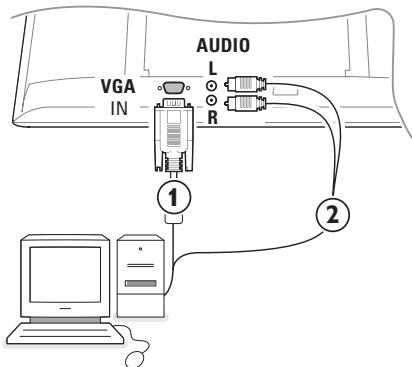
① Verbinden Sie das VGA-Kabel ① mit der Video-Karte des Computers und dem Fernsehgerät (**VGA IN**). Fixieren Sie die Stecker mit den beiden Halterschrauben.
