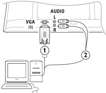
① Conecte uno de los extremos del cable VGA ① a la tarjeta de video del ordenador y el otro extremo al conector **VGA IN** que está en la parte de abajo del TV. Fije los conectores firmemente con tornillos en la conexión.
