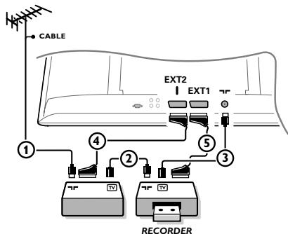
Csatlakoztassa az ábra szerint az ①, ② és ③ antennakábeleket (csak abban az esetben, ha a periféria rendelkezik TV-antenna be/kimenettel!). A kép minősége sokkal fog megjavulni, abban az esetben ha csatlakoztatja a ④ vagy ⑤ Eurokábelt a **EXT1** vagy 2-hoz.
