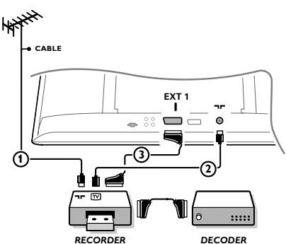
Ligue os cabos de antena **①**, **②** e, para obter uma melhor qualidade de imagem um eurocabo **③** como se indica. Se seu gravador não tiver um euroconector, a única ligação possível é através do cabo de antena. Para isso, deve sintonizar o sinal de teste do gravador e atribuí-lo o número 0 ou memorizar o sinal de teste sob um número de programa entre 90 e 99, veja Busca Manual, p. 7. Ver o livro de instruções do seu gravador.
