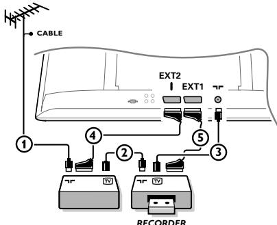
Podľa obrázku pripojte anténne káble ①, ② a ③ (ak má vaše periférne zariadenie iba anténnu vstup/výstup). Lepšiu kvalitu obrazu dosiahnete vtedy, keď vaše zariadenie pripojíte do konektoru **EXT. 1** alebo **2** eurokáblom ④ alebo ⑤.
