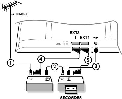
Kople til radiobølgekablene **①**, **②** og **③** som vist (bare hvis ditt periferiapparat har en radiobølge inn-/utgang for TV). Kople til ditt utstyr med en eurocable **④** eller **⑤** til en av eurotilkoplingene **EXT1** eller **2** for å oppnå bedre billedekvalitet.
