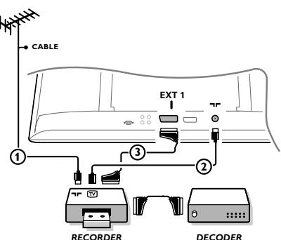
Подключите, как показано на рисунке, антенные кабели **①**, **②** и, для получения наилучшего качества изображения, еврокабель **③**. При отсутствии евроразъема, единственным возможным способом подключения является антенный кабель. Необходимо настроить телевизор на тестовый сигнал, выдаваемый записывающим устройством и назначить программу с номером 0, либо с номером в интервале от 90 до 99 (см. «Ручная установка», стр. 7).
