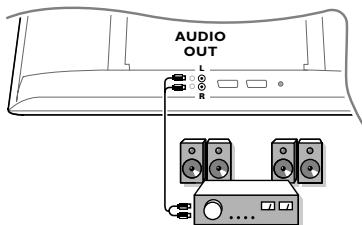
Για σύνδεση με σύστημα υψηλής πιστότητας (hi-fi), χρησιμοποιήστε ένα καλώδιο σύνδεσης ήχου και συνδέστε τις εξόδους **L** και **R AUDIO** της τηλεόρασης με τις εισόδους **AUDIO IN L** και **R** του ενισχυτή του hi-fi σας.
