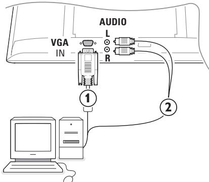
① Connectez par un câble VGA ① la carte vidéo de votre ordinateur avec la prise **VGA IN** du bas du TV. Serrez les vis de fixation de chaque prise.
