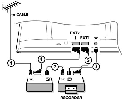
Tilslut antennekablerne ①, ② og ③ som vist (kun hvis det eksterne apparat har TV-antenneindgang og udgang). For at få bedre billedkvalitet forbinderes udstyret ved hjælp af et Eurokabel ④ eller ⑤ med Eurokonnektorerne **EXT1** eller **2** for at få bedre billedkvalitet.
