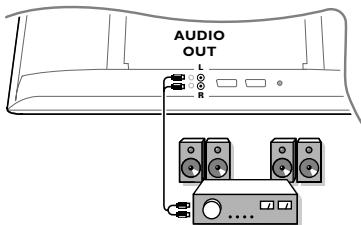
Ak chcete prijímač pripojiť k hi-fi systému, použite audio kábel pre pripojenie výstupov **L** a **R** TV prijímača k vstupom **AUDIO IN L** a **R** na hi-fi zosilňovači.
