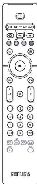
Drücken Sie die Taste **Select**, um den gewünschten Modus auszuwählen: **VCR**, **DVD**, **SAT**, **AMP** oder **CD**. Die Kontrolllampe der Fernbedienung zeigt den ausgewählten Modus an. Die Kontrolllampe erlischt automatisch nach 60 Sekunden ohne Aktion (Rückkehr zum TV-Modus).
