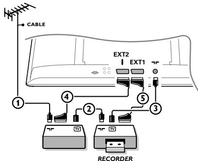
Branchez les câbles d'antenne ①, ② et ③ tel qu'indiqué (uniquement si votre périphérique dispose d'une entrée/sortie pour antennes TV).
