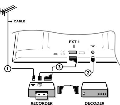
Připojte anténní kabely ① a ② a kabel SCART ③, díky kterému dosáhnete optimální kvality obrazu.
