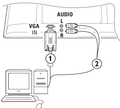
① Pripojte jeden koniec VGA kábla ① ku grafickej karte počítača a druhý koniec do **VGA IN** konektora na spodnej strane TV. Konektory zaistite pomocou skrutiek na zástrčke.
