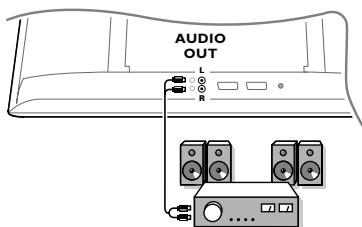
Aby podłączyć telewizor do systemu Hi-Fi, należy połączyć kablem audio wyjścia odbiornika telewizyjnego **AUDIO OUT L** i **R** z wejściami **AUDIO IN L** i **R** we wzmacniaczu.
