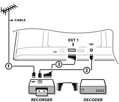
Collegate i cavi antenna **①**, **②** e, per ottenere una migliore qualità di immagine, un cavo scart **③** come viene mostrato. Se il vostro registratore non ha un euroconnettore, l'unica connessione possibile è tramite un'antenna. Pertanto dovrete sintonizzare il segnale di test del registratore ed assegnarvi il numero di programma 0 oppure memorizzare il segnale di test con un numero di programma fra 90 e 99, vedi Predispos. manuale, p. 7. Vedete anche il manuale del vostro registratore.
