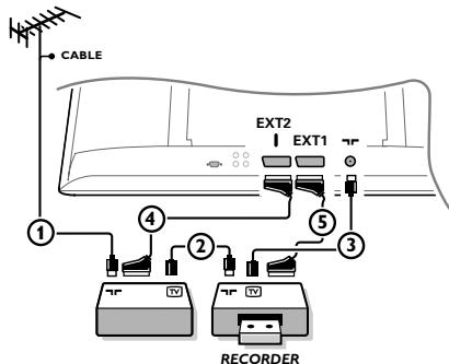
Sluit de antennekabels ①, ② en ③ aan zoals op de tekening hiernaast (enkel als uw randapparaat een in/uitgang voor TV-antenne heeft.) Sluit uw randapparaat door middel van een eurokabel ④ of ⑤ op een van de euroconnectors **EXT1** of **EXT2** aan om een betere beeldkwaliteit te verkrijgen.
