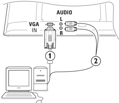
**①** Anslut ena änden av VGA-kabel **①** till datorns videokort och den andra änden till **VGA IN**-kontakten på TV'n s undersida. Lås kontakterna med fästskruvarna.
