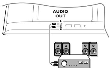
Brug et audiokabel for at tilslutte fjernsynet til et Hi-Fi-anlæg. Forbind L og R på fjernsynet med **AUDIO IN L** og **R** på forstærkeren.
