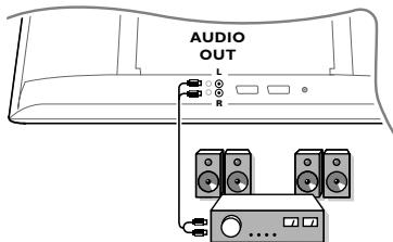
Для подключения hi-fi-аудиосистем используйте соединительный аудиошнур. Соедините разъемы аудиовыхода **AUDIO OUT L** (левый) и **R** (правый) телевизора со аудиовходами **AUDIO IN L** и **R** усилителя.
