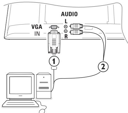
❶ Verbind een uiteinde van een VGA kabel ① met de videokaart van de computer en verbind het andere uiteinde met de **VGA IN** connector aan de onderzijde van de TV. Sluit de connectoren stevig aan door middel van de schroeven op de stekker.
