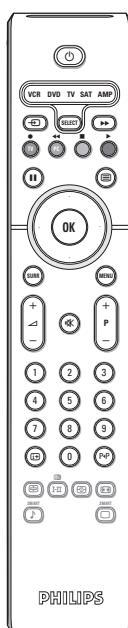
Appuyez sur la touche **Select** pour sélectionner le mode désiré : **VCR** (magnétoscope), **DVD**, **SAT** (satellite), **AMP** (amplificateur) ou **CD**.
