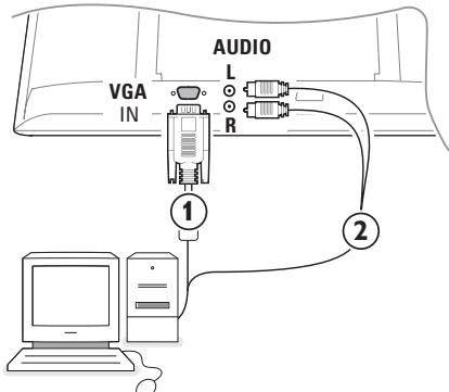
**1** Ligue uma extremidade do cabo VGA **①** à saída video do computador e a outra extremidade da ligação **VGA IN** à parte de baixo do TV. Fixe os cabos apertando os parafusos das fichas.
