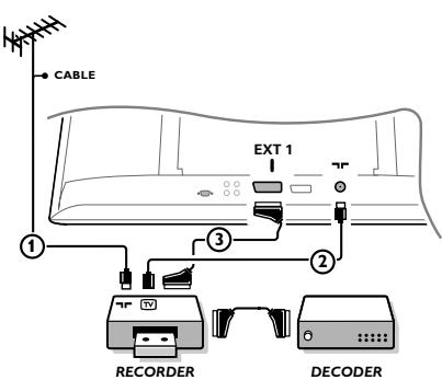
Antennekablerne ①, ② og, for opnå en bedre billedkvalitet, Eurokabel ③ tilsluttes som vist på billedet. Hvis Deres optager ikke er udstyret med Eurokontaktor, er den eneste mulige tilslutning via antennekablet. Det er derfor nødvendigt at opsøge optagerens testsignal og tildele det programnummer 0 eller lavere testsignalet på et programnummer mellem 90 og 99, se Manuel installering på side 7. Jfr. håndbogen for Deres optager.
