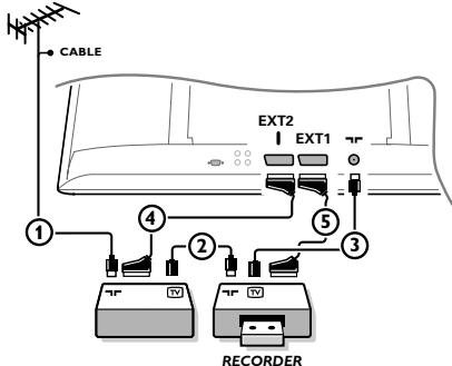
Anslut antennkablaarna **①**, **②** och **③** enligt anvisningarna (endast om din extrautrustning har in/utgång för TV-antenn). Anslut din utrustning med eurokabel **④** eller **⑤** till ett av euro-uttagen **EXT1** eller **2** för att få bättre bildkvalitet.
