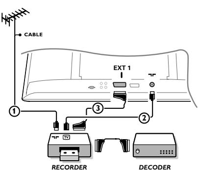
Antennekablene ① og ② tilkobles som vist på tegningen ved siden av. Bildekvaliteten kan forbedres hvis man også tilkabler en eurokabel ③. Hvis videomaskinen din ikke har noen eurotilkopling, kan den utelukkende tilkopes over en radiobølgekabel. Det vil da være nødvendig å stille inn testsignalet på videomaskinen og å anvende det på program nummer 0 eller å lagre testsignalet under et programnummer mellom 90 og 99, se Manual lagring, s.7. Se håndboken for opptakeren.
