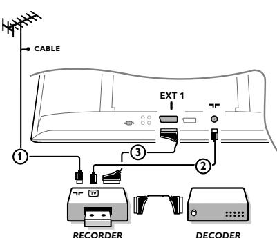
Sluit de antennekabels **①**, **②** en, om een betere beeldkwaliteit te verkrijgen, een eurokabel **③** aan zoals op de tekening. Indien uw recorder geen euroconnector heeft, kunt u hem alleen via de antennekabel aansluiten. Hiervoor moet u het testsignaal van uw recorder afstemmen en er het programma-nummer 0 aan toekennen, of het testsignaal opslaan onder een programmanummer tussen 90 en 99, zie Handmatige installatie, p. 7.
