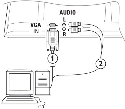
**①** Collegare un capo del cavo VGA **①** al connettore del PC e l'altro capo al connettore **VGA IN** posto sulla parte inferiore del TV. Fissare le spine VGA ai connettori tramite le viti di serraggio.
