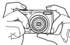
Drehen Sie bei Aufnahmen im Hochformat die Kamera so, dass sich der eingebaute Blitz oberhalb des Objektivs befindet.
