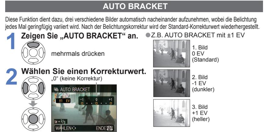
Nach Einstellung der Belichtungskorrektur wird der Korrekturwert angezeigt.
