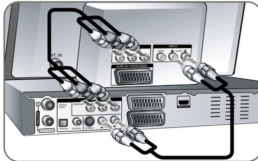
Wenn es sich bei Ihrem Fernseher um ein HDTV- oder ein "Digital Ready"-Gerät handelt, können Sie den Progressive Scan-Ausgang des Gerätes verwenden, um die höchstmögliche Bildauflösung zu erhalten. Falls der Fernseher Progressive Scan nicht unterstützt, erscheint das Bild des Progressive-Signals verzerrt. Stellen Sie über die Taste RES. auf dem Bedienungsfeld die Auflösung für das Progressive-Signal auf 576p ein.
