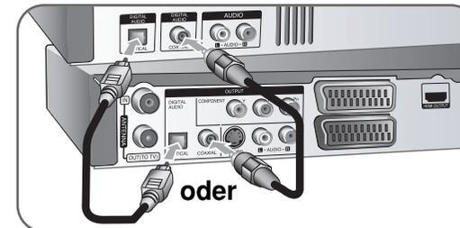
Dieser Rekorder führt keine interne (2 Kanal) Decodierung von DTS-Tonspuren durch. Um DTS-Mehrkanal-Surround zu genießen, muss dieser Rekorder über einen der digitalen Audioausgänge an einen DTS-kompatiblen Receiver angeschlossen werden.
