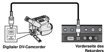
Diese DV IN-Buchse ist ausschließlich für den Anschluss eines digitalen DV-Camcorders vorgesehen und ist nicht kompatibel mit digitalen Satellitenempfängern oder D-VHS-Videogeräten. Beim Trennen des DV-Kabels während der Aufnahme von einem angeschlossenen digitalen Camcorder kann es zu Fehlfunktionen kommen.
