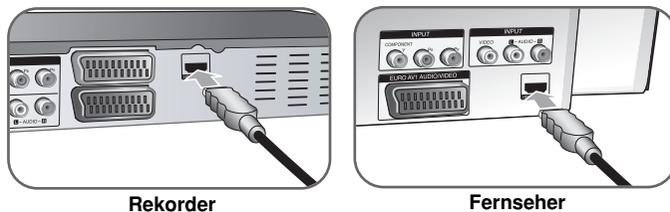
Bei einem HDMI-Anschluss kann die Auflösung (576i, 576p, 720p, 1080i oder 1080p) für den HDMI-Ausgang durch mehrmaliges Drücken der Taste RES. auf dem Bedienungsfeld eingestellt werden.
