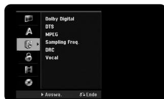
**Dolby Digital / DTS / MPEG** – Wählen Sie die Art des digitalen Audiosignals beim Anschluss über die DIGITAL AUDIO-Ausgangsbuchse.
