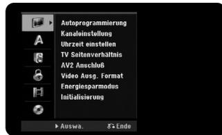
**Autoprogrammierung** – Diese Option sucht und speichert automatisch alle empfangenen Kanäle.
