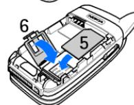
Remplacez la batterie (7). Vérifiez le bon positionnement des connecteurs de la batterie. Utilisez toujours des batteries Nokia d'origine. Voir [Procédure d'authentification des batteries Nokia](#) p. 135.
