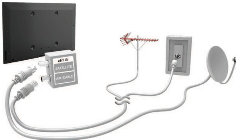
Am besten verbinden Sie beide Anschlüsse mit einem Multischalter oder DiSEqC. Schalter usw. Stellen Sie außerdem **Antennen-Verbindungstyp** auf **Dual** ein.
