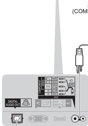
Für Wiedergabe von mehrkanaligem Ton (z. B. im 5,1-kanaligen Dolby Digital-Format) schließen Sie das Zusatzgerät an den Verstärker an. Einzelheiten zu den Anschlüssen finden Sie in den Bedienungsanleitungen des Zusatzgerätes und des Verstärkers.
