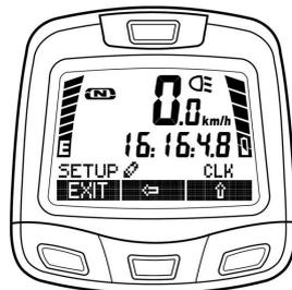
Premendo il pulsante freccia "↑" è possibile modificare le cifre intermittenti. Premendo il pulsante freccia "→" si accede alla fase seguente della procedura di impostazione, ovvero dall'indicazione delle ore a quella dei minuti e così via.
