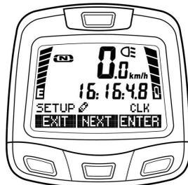
Per accedere alla modalità di modifica dell'ora premere "ENTER" dalla schermata SETUP->CLK. La parte di volta in volta modificabile dell'ora/data viene visualizzata in maniera intermittente.
