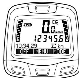
calcola i chilometri percorsi. Questa indicazione è modificabile in un sottomenu onde permettere per esempio di inserire nel sistema anche i chilometri percorsi con una precedente bicicletta.
