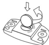
1. Öffnen Sie die Batterieabdeckung der Sendeeinheit, indem Sie sie mithilfe einer Münze gegen den Uhrzeigersinn von der Markierung CLOSE zu der Markierung OPEN drehen.
