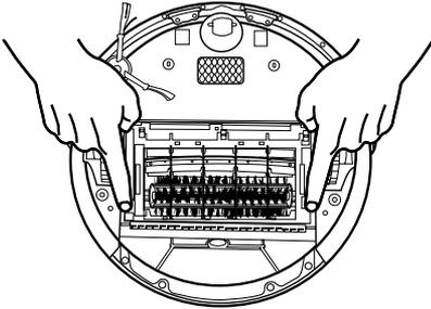
B. Entfernen und reinigen Sie die Bürsten von Roomba.
