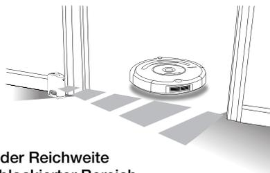
Mithilfe von Virtual Walls kann eine Öffnung von bis zu zwei Metern blockiert werden. Beachten Sie, dass der Strahl der Virtual Wall mit zunehmender Reichweite auch breiter wird. So entsteht ein immer größerer blockierter Bereich, den Roomba nicht durchqueren kann. Die Virtual Wall erstellt auch einen Schutzbereich um sich selbst herum, damit Roomba ihr nicht zu nahe kommt.
