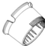
**⚠** Übermäßige Haaransammlungen können Roomba dauerhaft schädigen. Entfernen Sie regelmäßig die Bürsten und untersuchen Sie die Bürstenlager.
