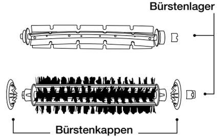
**TIPP:** Achten Sie bei der Wartung von Roomba auf gelbe Teile. Diese Teile sollten bei jedem Entleeren des Behälters entfernt und gereinigt werden.
