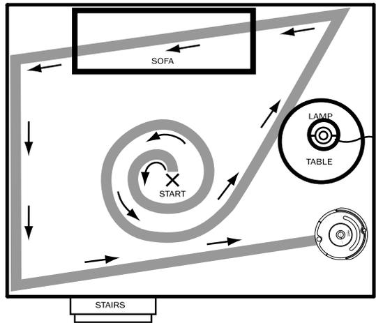
**TIPP:** Roomba benötigt etwa 25 Minuten für die Reinigung eines Raums von durchschnittlicher Größe. Dabei bearbeitet er jeden Bereich des Bodens mehrmals, damit auch wirklich der gesamte Boden abgedeckt wird.
