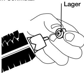
D. Entfernen und reinigen Sie die Bürstenkappen.
