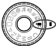
Placez la molette de sélection des modes sur
