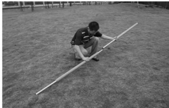
2. Insérez le capuchon à l'extrémité du tube supérieur et l'embout sol sur le tube inférieur. Pour terminer, enfichez le tube inférieur dans le supérieur.
