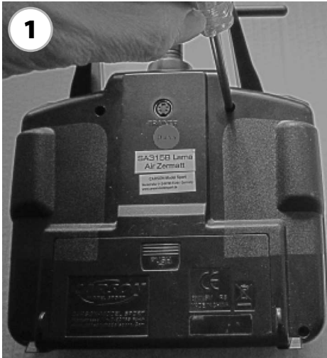
1. Lösen Sie alle 4 Schrauben an der Rückseite des Senders.
