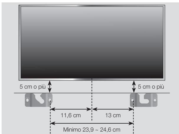
1. Posizionare la "Staffa per montaggio a parete sinistra" sulla parete desiderata tenendola parallela al pavimento come mostrato qui sopra; inserire una vite nel foro all'estremità destra e bloccarla.
