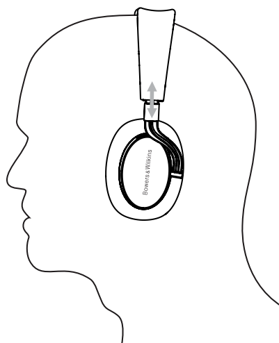
図4 イヤーピースを調整する
