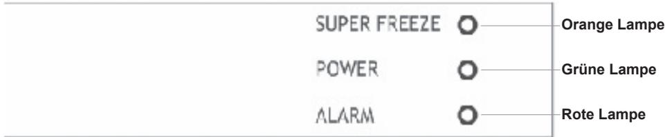
**ORANGE LAMPE:** Wenn das Gerät im “Superfriermodus” ist (Thermostatregler in Stellung SF), leuchtet die orange Lampe.
