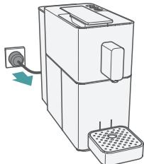
Beim Transportieren und Lagern darf sich kein Wasser im Gerät befinden.
