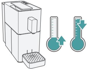
Ist die Temperatur des Gerätes unter 5 °C oder sehr hoch, kann sie nicht gestartet werden und alle Tasten blinken schnell.
