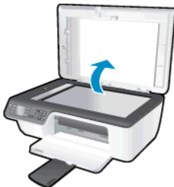
2. Legen Sie das Original mit der bedruckten Seite nach unten so auf das Scannerglas, dass es an der rechten Ecke anliegt.
