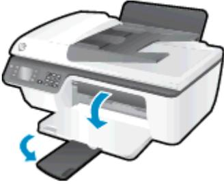
3. Klappen Sie die Schutzabdeckung des Zufuhrfachs hoch, schieben Sie die Papierquerführung nach links und nehmen Sie sämtliches Papier aus dem Zufuhrfach.
