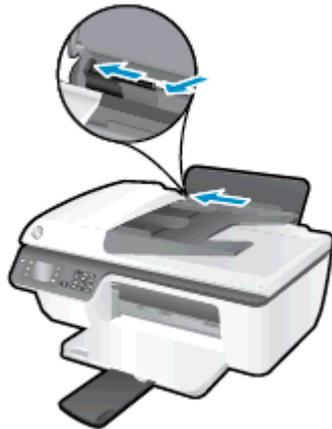
4. Legen Sie den Fotopapierstapel mit der schmalen Kante nach unten und der zu bedruckenden Seite nach oben ein. Schieben Sie dann den Papierstapel bis zum Anschlag nach unten.
