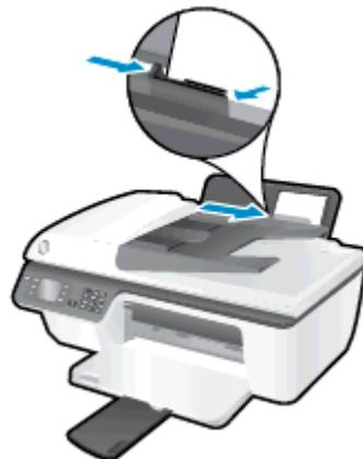
5. Klappen Sie die Schutzabdeckung des Zufuhrfachs hoch und schieben Sie die Papierquerführung nach rechts bis an die Papierkanten heran.
