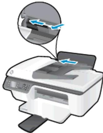
4. Legen Sie den Papierstapel mit der schmalen Kante nach unten und der zu bedruckenden Seite nach oben in das Zufuhrfach ein. Schieben Sie dann den Papierstapel bis zum Anschlag nach unten.
