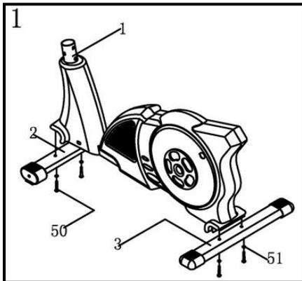
1. Befestigen Sie den vorderen (2) und hinteren Stabilisator (3) mit den Schlossschrauben (50) Unterlegscheiben (51) von unten am Hauptrahmen (1).
