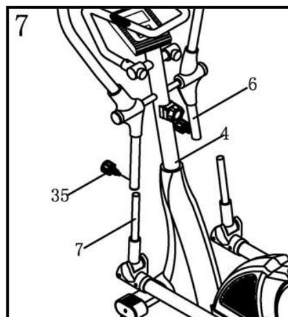
1. Lösen Sie den schwarzen Knopf (35) am rechten Griffbügel (6). Befestigen Sie dann den Griffbügel an der Pedalstange (7). Wählen Sie die gewünschte Höhe mit Hilfe des Knopfs.
