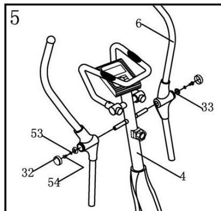
1. Montieren Sie den rechten Griffbügel (6) an der Achse der Lenkerstütze (4) mit Hilfe einer Zwischenscheibe (33), Unterlegscheibe (53), Schraube (54) und der Abdeckung (32).
