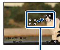
Cadre du télémètre AF (jaune : réglable/blanc : fixe)
